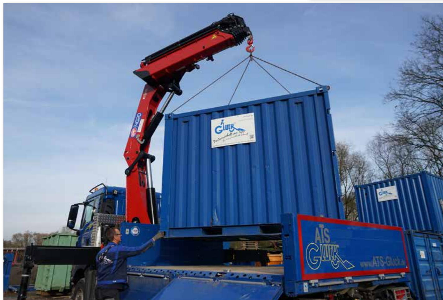
Der Ladekran HMF 4020 hat sechs Ausschübe und kann eine Last von 4,4 Tonnen bis zu sechs Meter nach vorne über das Fahrerhaus heben. Als Chassis wurde ein MAN mit einem dreiachsigen TGS 28 500 mit zwangsgelenkter Liftachse verwendet.
