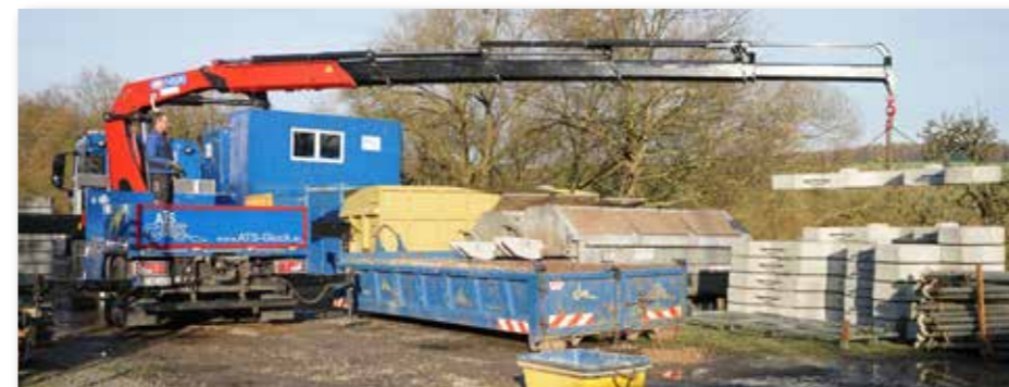
Der Aufbaubetrieb ATLAS NORDHESSEN sowie das neigungsabhängige Standsicherheitssystem EVS waren entscheidend für die Wahl eines HMF-Ladekrans
