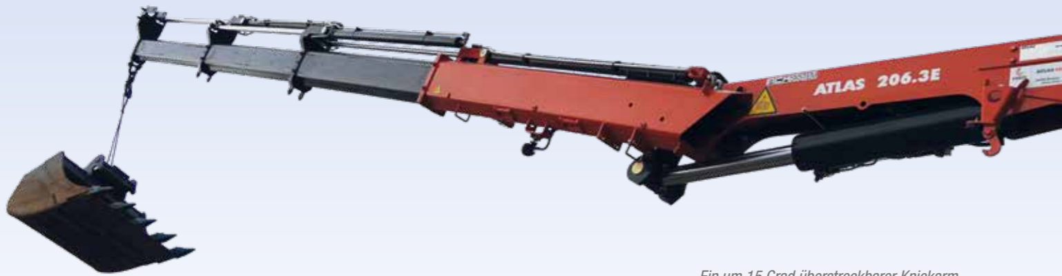
Ein um 15 Grad überstreckbarer Knickarm für einen größeren Arbeitsbereich
