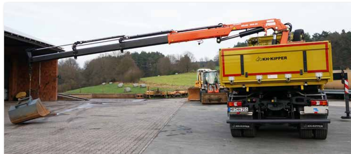
Das Standsicherheitssystem Ahmeko kommt ganz ohne Messung der Abstützlängen aus.
